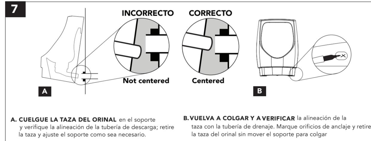
**7 A. CUELQUE LA TAZA DEL ORINAL** en el soporte y verifique la alineación de la tubería de descarga; retire la taza y ajuste el soporte como sea necesario.
