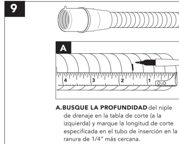
**9 A. BUSQUE LA PROFUNDIDAD** del niple de drenaje en la tabla de corte (a la izquierda) y marque la longitud de corte especificada en el tubo de inserción en la ranura de 1/4" más cercana.
