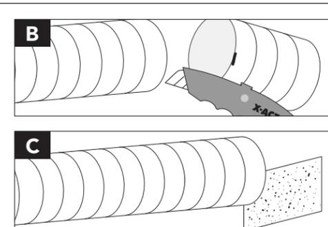
**10 B. CORTE EL TUBO** en la ranura usando una navaja con filo para asegurar un corte rectangular plano.
