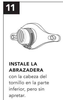
**14 INSTALE LA ABRAZADERA** con la cabeza del tornillo en la parte inferior, pero sin apretar.
