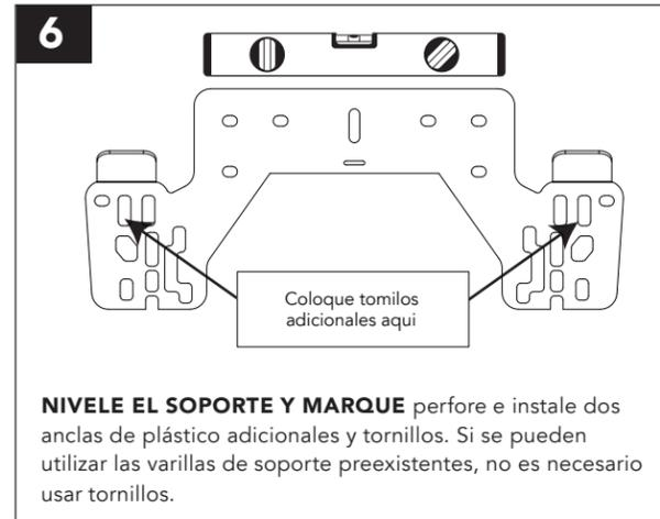
**6 NIVELE EL SOPORTE Y MARQUE** perfore e instale dos anclas de plástico adicionales y tornillos. Si se pueden utilizar las varillas de soporte preexistentes, no es necesario usar tornillos.
