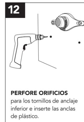
**15 PERFORE ORIFICIOS** para los tornillos de anclaje inferior e inserte las anclas de plástico.
