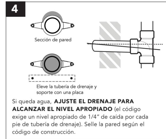
**4** Eleve la tubería de drenaje y soporte con una placa
