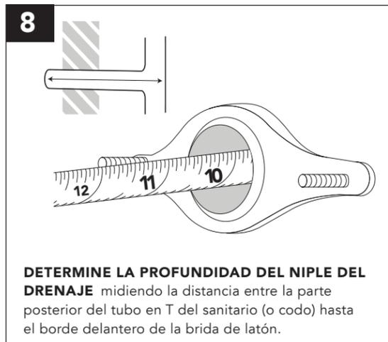
**8 DETERMINE LA PROFUNDIDAD DEL NIPLE DEL DRENAJE** midiendo la distancia entre la parte posterior del tubo en T del sanitario (o codo) hasta el borde delantero de la brida de latón.
