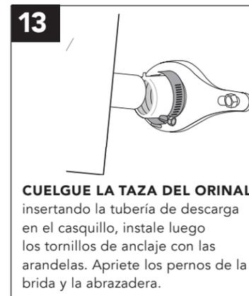
**16 CUELQUE LA TAZA DEL ORINAL** insertando la tubería de descarga en el casquillo, instale luego los tornillos de anclaje con las arandelas. Apriete los pernos de la brida y la abrazadera.
