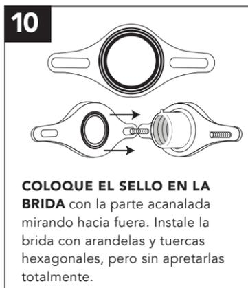
**13 COLOQUE EL SELLO EN LA BRIDA** con la parte acanalada mirando hacia fuera. Instale la brida con arandelas y tuercas hexagonales, pero sin apretarlas totalmente.
